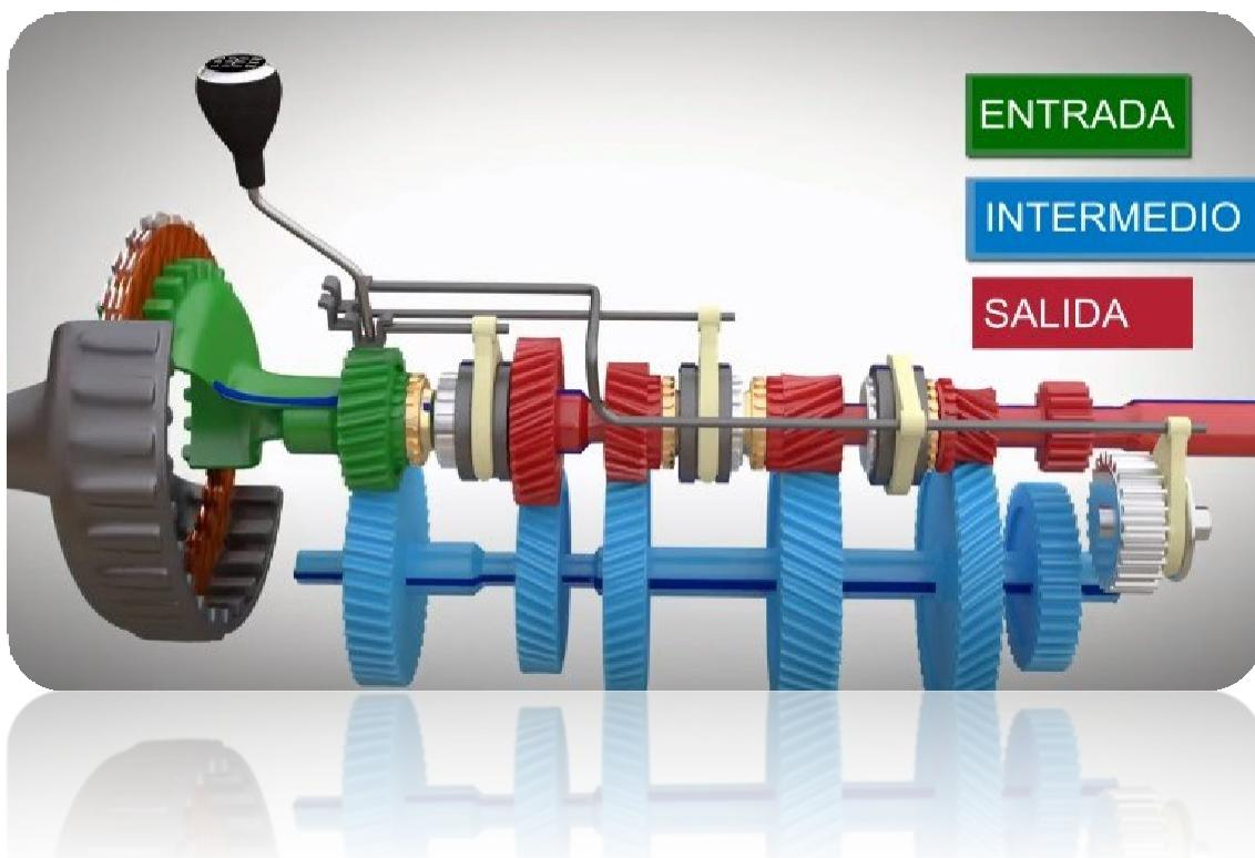
**Para conocer el funcionamiento de los distintos tipos de transmisión que puede llevar equipado nuestro vehículo, es imprescindible conocer los diferentes elementos que componen este sistema:**
