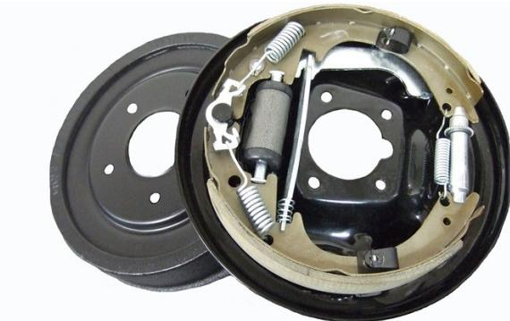
**Freno de estacionamiento o de mano:** Este sistema de frenos tan solo actúa en las ruedas traseras para evitar que el vehículo se mueva mientras está estacionado.
